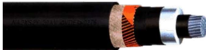
*Slika 34: Jednožilni energetski kabal izolovan polietilenom i plaštiran PE-masom, prema DIN VDE 0295, nazivnog napona 12/20 kV*
